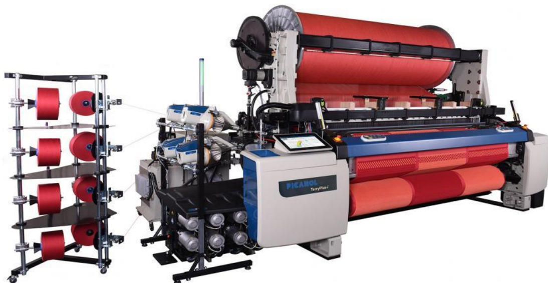
TerryPlus-i u kombinaciji sa elektronskim formiranjem zeva
